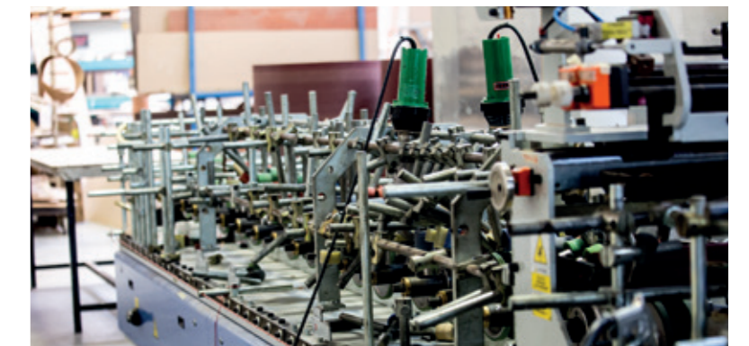
Fase di rivestimento con tranciato su profili per porte Veneer lining phase on profiles for doors Фазы облицовки шпоном филенок дверей
